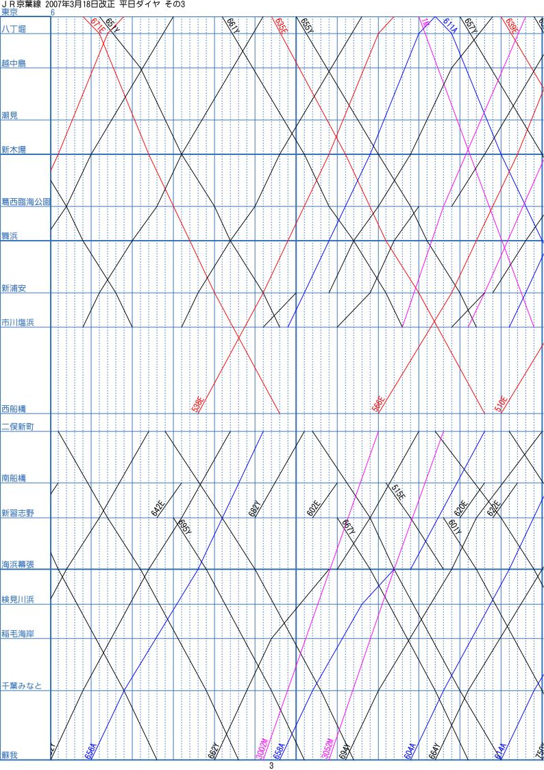
JR京葉線 2007年3月18日改正 平日ダイヤ その4 東京\_\_\_\_\_7 八丁堀 越中島 潮見 新木場 葛西臨海公園 舞浜 新浦安 市川塩浜 西船橋 二俣新町 南船橋 Soft. X5.64 新習志野 海浜幕張 検見川浜 稲毛海岸 千葉みなと 蘇我
